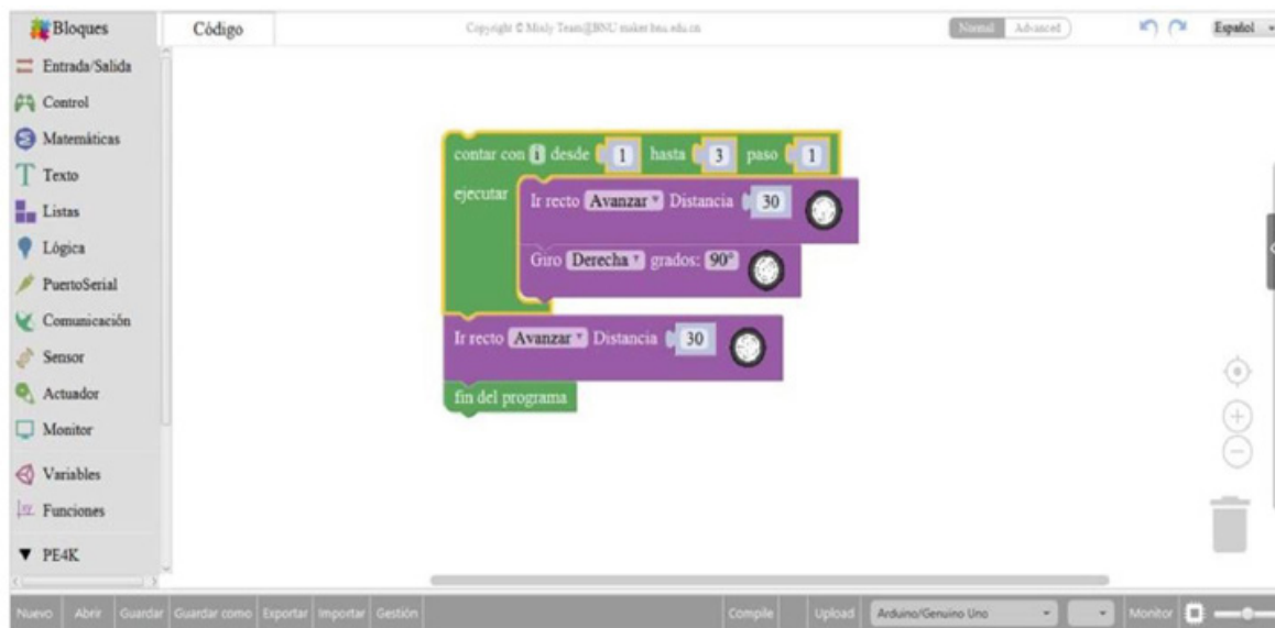
Figura 4. Entorno PE4K. Tomado de "Entorno Grafico de Programación para un Modelo de Robot Móvil Diferencial como Herramienta de Aprendizaje Orientada a Niños" por Negrín, 2018.
